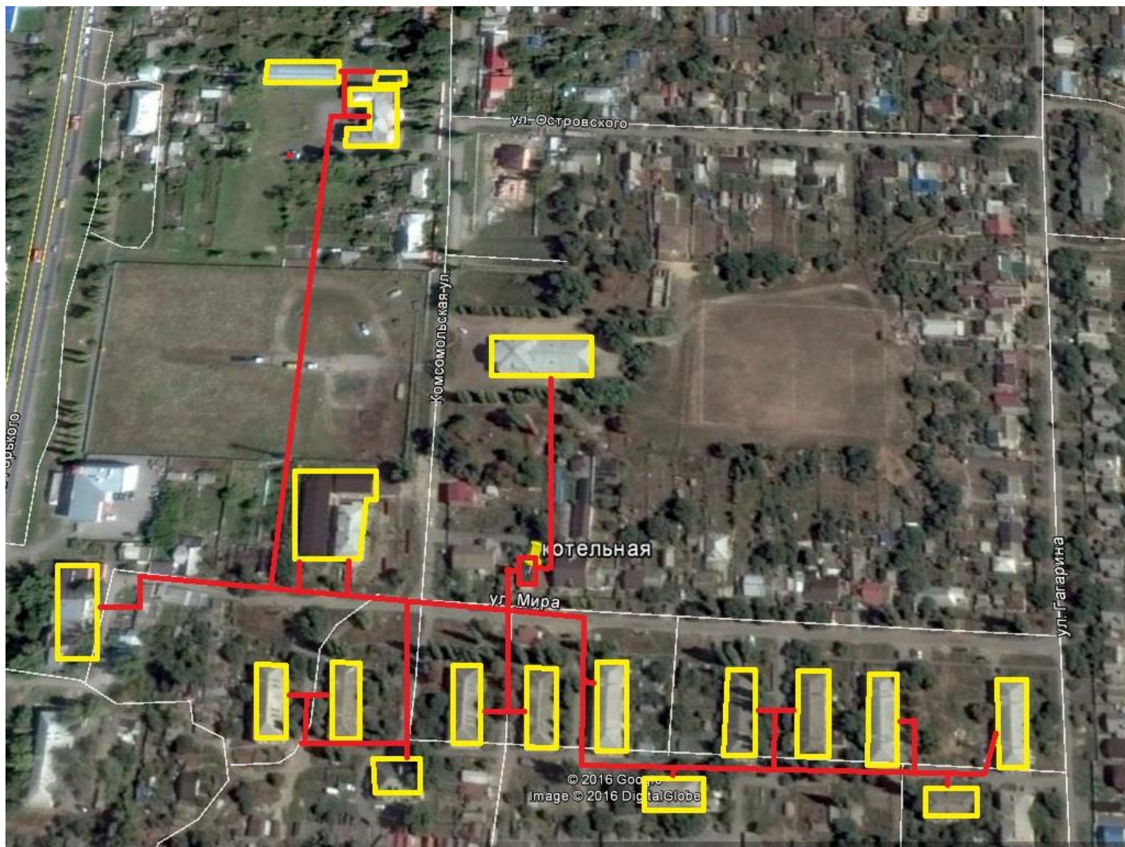
Рисунок 1. – Зона теплоснабжения Котельной №1 п. Овощной Обильненского сельского поселения Азовский р-н, Ростовская обл.
